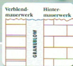
**KERNDÄMMUNG GRANUBLOW** – ein speziell für die maschinelle Hohlräumfüllung von zweischaligem Mauerwerk entwickelter Einblasdämmstoff.
